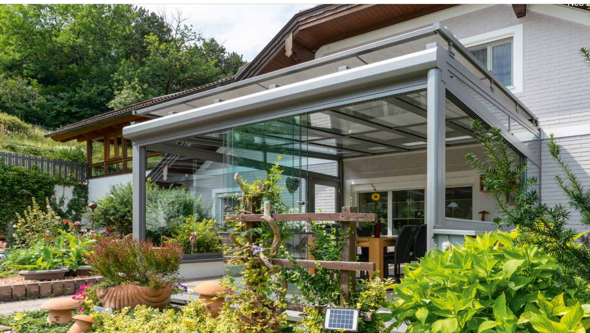
Die heiße Luft zwischen der Außenbeschattung und dem Glasdach kann oben entweichen.
