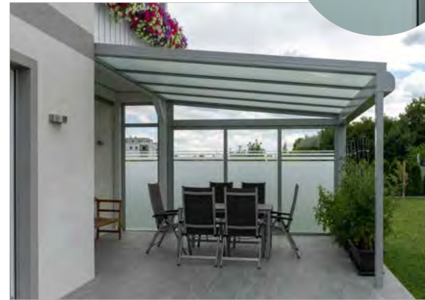
Fixe Glaswand zur Straße mit Streifenmuster foliert.
