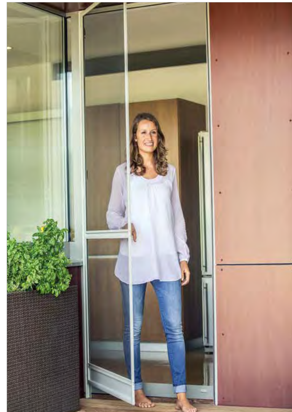
Drehtüren mit Magnetleiste 41 mm Rahmen mit 50 mm Griffsporse auf 105 cm Standardhöhe und 100 mm Sockelblech, oder wahlweise mit 55 mm Rahmen ohne Griffsporse Maximale Größe 130x250 cm.
