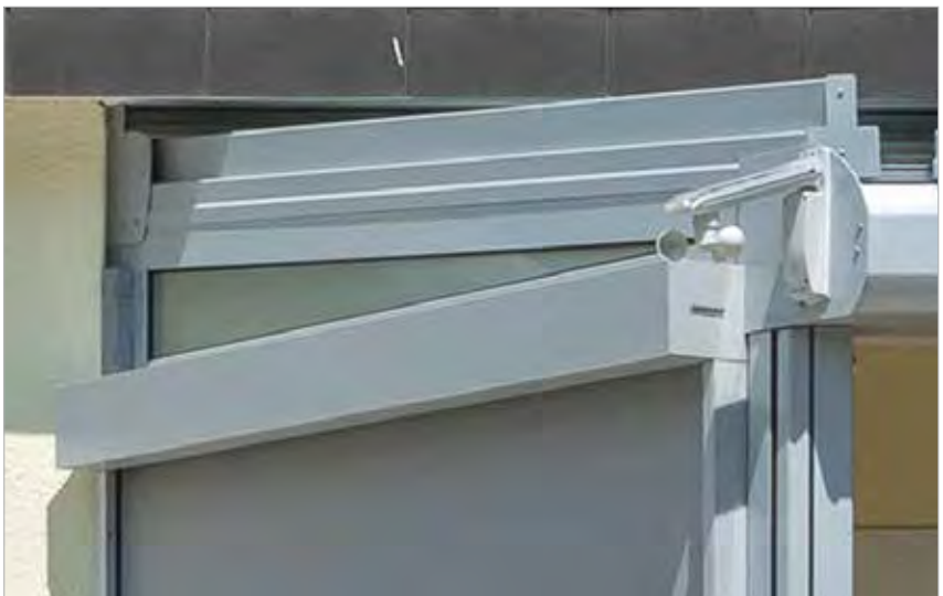
Zipline mit sichtbarem quadratischen Kasten auf Sommergarten. Kastengröße: 9x9 cm bis 250 cm Breite, 11x11cm bis 300 cm Breite, 13x13 cm bis 450 cm Breite, 15x15 bis 600 cm Breite. Führungsschienen 29x46 mm.
