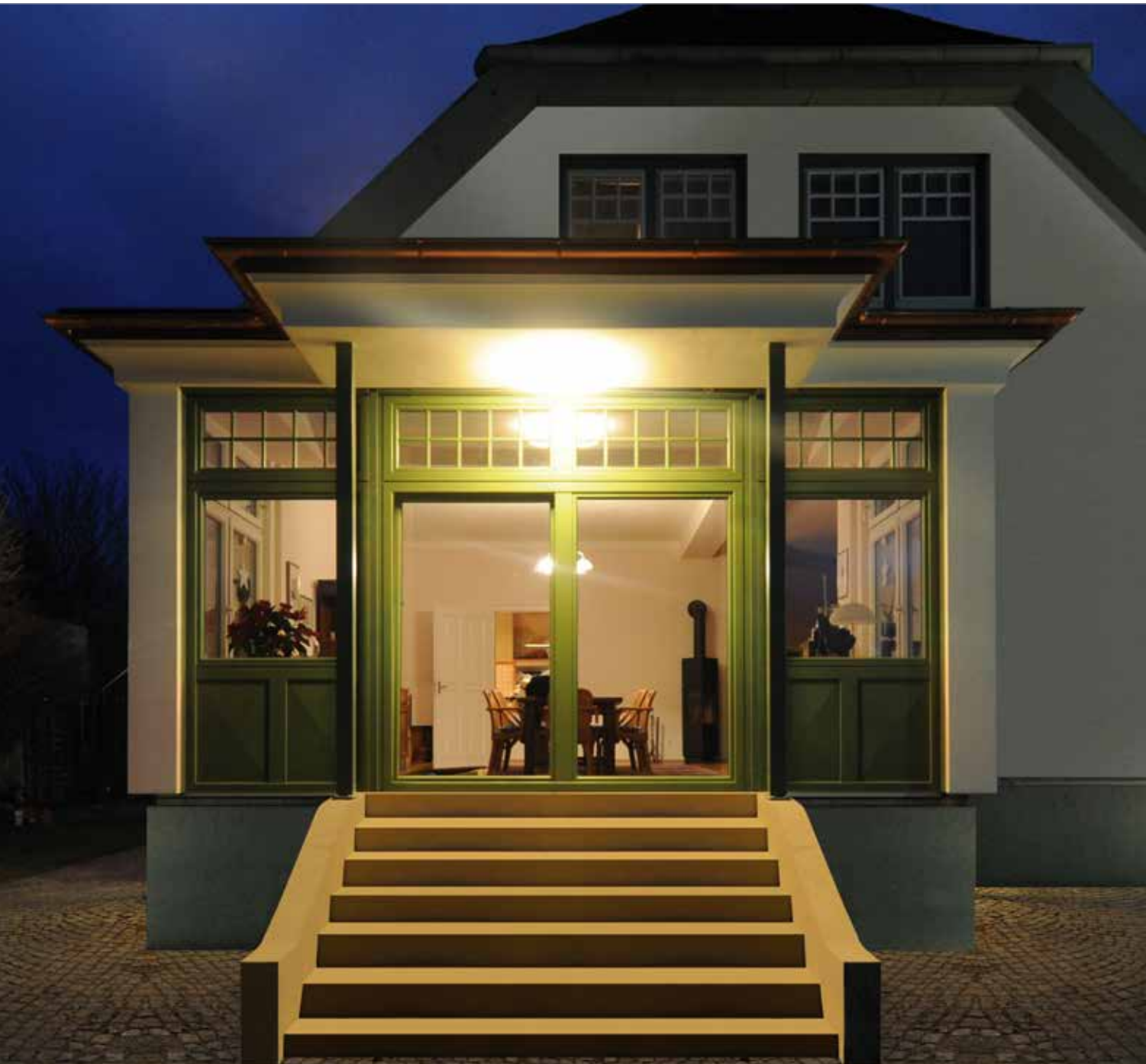
Klassik-Wintergarten mit verputzten Ecksäulen und umlaufendem Gesims mit Hohlkehle. In den Garten führt eine flache Stiege mit 14 cm Stufenhöhe und 35 cm Stufenbreite.
